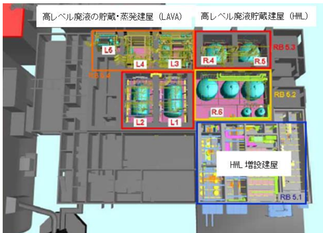
図 1 WAK 施設の解体ステップ 5 の解体建屋 (HWL と LAVA) 2)
