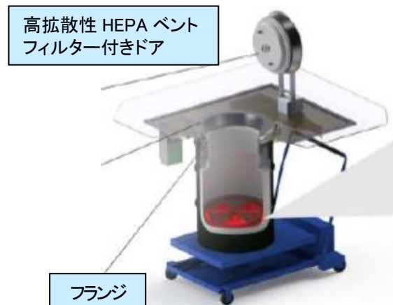
図 3 WDTS (TRU 廃棄物ドラム缶輸送システム) の概念図
